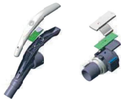
Die Verbindung erfolgt über die elektronischen Platinen
